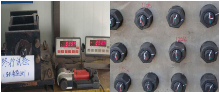
图2.2.7 终拧转动状态及终拧标记例照（左实验室实测、右现场状态）
